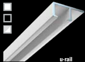
u-rail, ophangstelsel 20 kg/m | 6,5 x 14 mm
